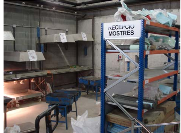
PSot: Zona de recepció de mostres, on es recepcionen i identifiquen totes les mostres que recollim a les diverses obres, exceptuant les provetes de formigó (tenen una ubicació independent). També tenim una zona d'assecadors per poder assecar amb el mínim de temps aquelles mostres de sòls que arriben humides al laboratori.
