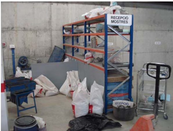
PSot: Zona de recepció de mostres, on es recepcionen i identifiquen totes les mostres que recollim a les diverses obres, exceptuant les provetes de formigó (tenen una ubicació independent). També tenim una zona d'assecadors per poder assecar amb el mínim de temps aquelles mostres de sòls que arriben humides al laboratori.
